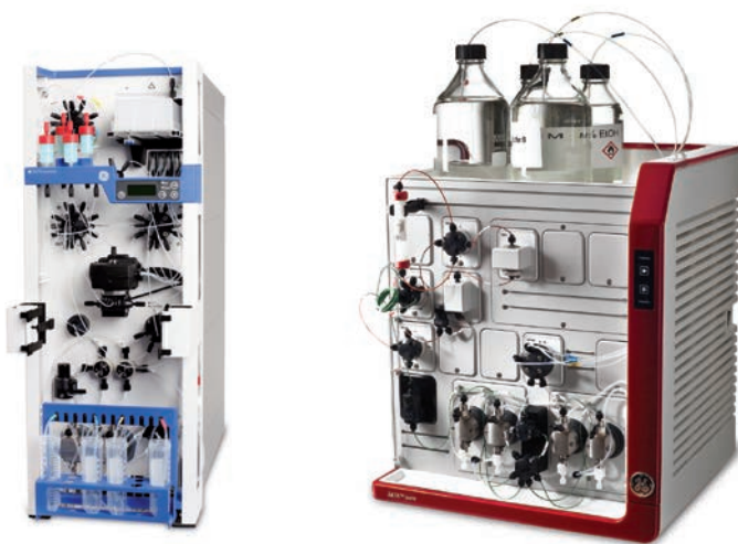
Fig 5.3. ÄKTExpress single (left) and ÄKTA pure chromatography systems.
